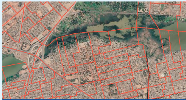
Milieu urbain : ZD digitales (Limites en rouge) superposées aux images google sur QGIS
